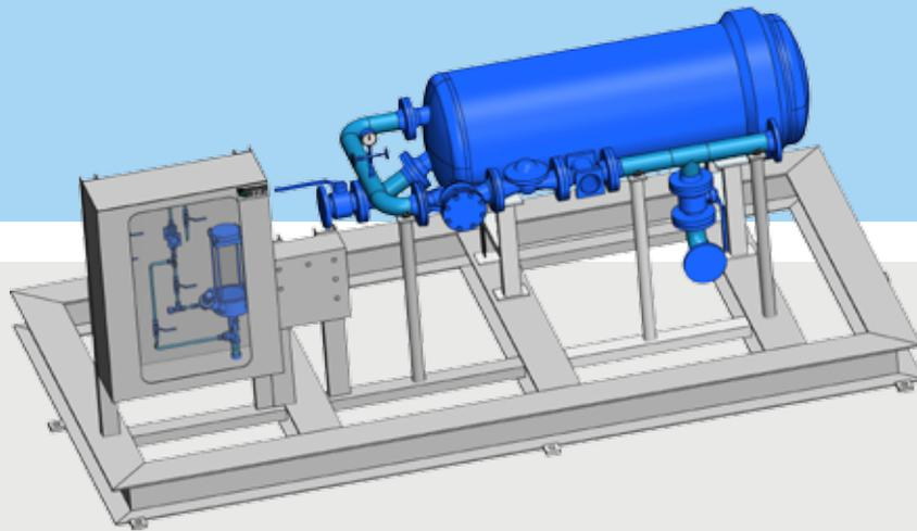
Den Flugzeugbetankung Skid haben wir speziell für das Betanken der Flugfeld-Tankwagen bzw. Flugzeugen konzipiert.
